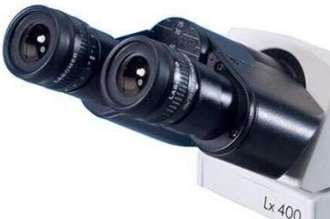
La Serie RP Plan con óptica infinita, objetivos plan acromáticos y oculares enfocables de campo amplio ofrecen imágenes grandes y precisas en cada observación. El sistema es modular para aplicaciones digitales, fluorescentes y de contraste de fases.
