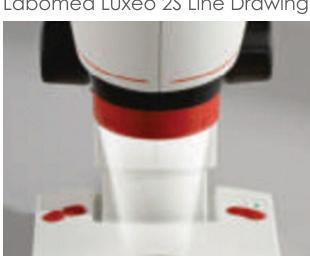
Una luz de anillo LED de +/- 30 grados permite a los usuarios reducir el resplandor de la superficie de las topografías reflectantes para una verdadera iluminación oblicua de LED. La brillante iluminación transmitida por LED también se logra con una pantalla luminosa de 3 LED.
