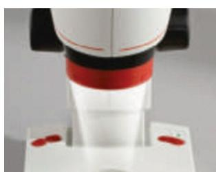
Una luz de anillo LED de +/- 30 grados permite a los usuarios reducir el resplandor de la superficie de las topografías reflectantes para una verdadera iluminación oblicua de LED. La brillante iluminación transmitida por LED también se logra con una pantalla luminosa de 3 LED. El control de intensidad continua se gestiona a través de un dial de control en la luz del anillo.
