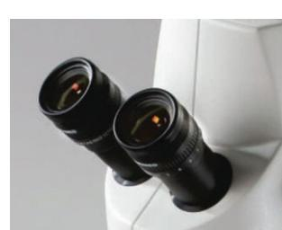
La óptica plana de alta precisión y los recubrimientos superiores garantizan una reproducción precisa del color, una excelente profundidad de enfoque y una resolución superior. Una gama de oculares enfocables aseguran conveniencia e intercambiabilidad.
