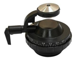
Sobre el módulo del analizador/lente de Bertrand se encuentran localizadas dos ranuras de placa del compensador y dos ranuras del mecanismo de centrado para prevenir una pérdida no deseada de accesorios. El microscopio viene equipado con placas  $\lambda$ ,  $1/4 \lambda$ , and cuña de cuarzo.
