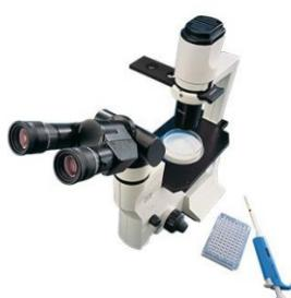
Los objetivos de larga distancia de trabajo de la serie LWD y un sistema de iluminación de contraste de fase y campo claro bien diseñado ofrecen imágenes con un contraste nítido. Un condensador de fase de larga distancia de trabajo de apertura numérica N.A. 0.8 adapta diferentes recipientes de cultivo con facilidad.
