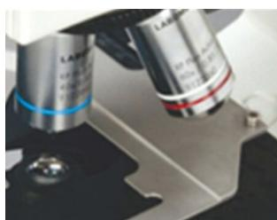
Objetivos Serie RP2 de óptica infinita Super Plan acromática que ofrecen un campo de visión virtualmente plano en todos los aumentos, con un contraste y fidelidad de color nítidos. Los recubrimientos patentados MaxLite mejoran aún más su desempeño óptico.
